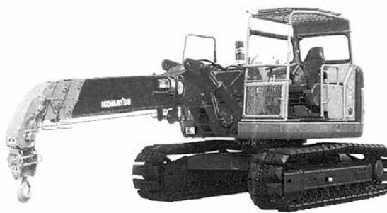
4.9t後方小旋回/3段ブーム LC1385-1(地下仕様型)
