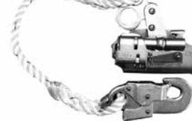
78口リップは、レバーひとつのワンタッチ操作により電柱、鉄塔、梯子等を昇降する作業者の墜落を未然に防ぐ（昇降用）とともに任意の位置で作業する際の墜落を防ぐ、（定位位置作業用）2種類の性能を有した墜落防止器具です。親綱への取り付けは、ワンタッチ操作により簡単にかつ確実に行え、昇降時には作業者の上下移動に応じて親綱上をスムーズにスライドし、定位位置作業時には親綱の任意の位置に固定することができます。
