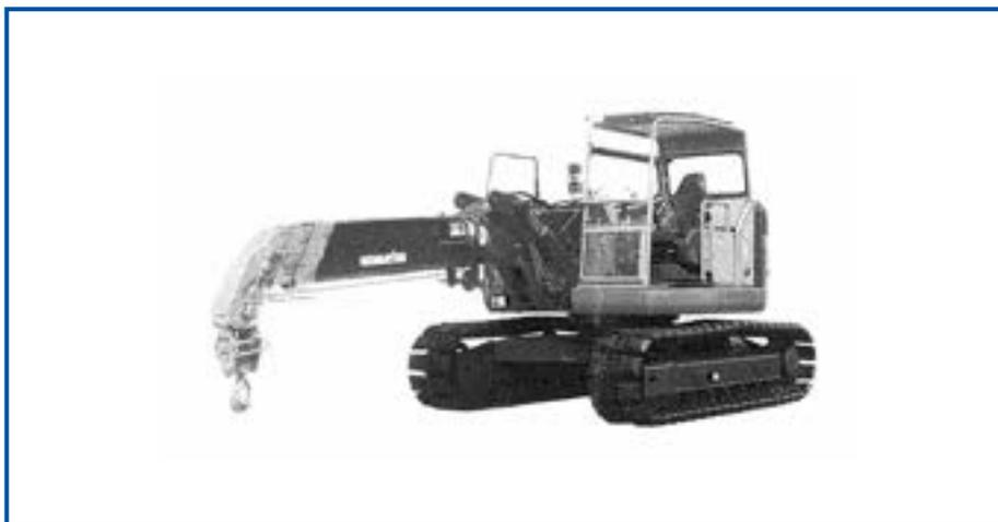
4.9t後方小旋回/3段ブーム LC1385-1 (地下仕様型)
