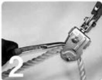
2 ラチェットの先端部分を歯形の凹部に差し込み、下に押し下します。
