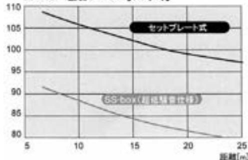
\* F22の騒音レベルは、機体15m地点の実測値で、セットプレートタイプ：103dB(A)、SS-box型低騒音仕様：94 dB(A)です。
