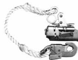
78ロリップは、レバーひとつのワンタッチ操作により電柱、鉄塔、梯子等を昇降する作業者の墜落を未然に防ぐ（昇降用）とともに任意の位置で作業する際の墜落を防ぐ、（定位置作業用）2種類の性能を有した墜落防止器具です。親綱への取り付けは、ワンタッチ操作により簡単にかつ確実に行え、昇降時には作業者の上下移動に応じて親綱上をスムーズにスライドし、定位置作業時には親綱の任意の位置に固定する事が出来ます。
