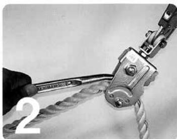
ラチェットの先端部分を歯形の凹部に差し込み、下に押します。
