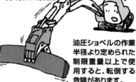
油圧ショベルの作業半径より定められた制限重量以上で使用すると、転倒する危険があります。
