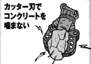
カッター刃が摩耗し、鉄筋が切れなくなります。
