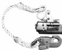
78ロリップは、レバーひとつのワンタッチ操作により電柱、鉄塔、梯子等を昇降する作業者の墜落を未然に防ぐ(昇降用)とともに任意の位置で作業する際の墜落を防ぐ、(定位置作業用)2種類の性能を有した墜落防止器具です。親綱への取り付けは、ワンタッチ操作により簡単にかつ確実に行え、昇降時には作業者の上下移動に応じて親綱上をスムーズにスライドし、定位置作業時には親綱の任意の位置に固定する事が出来ます。
